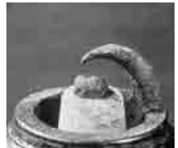
↑ Figura 1.54. Bujía con desgaste de electrodos.
