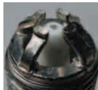
↑ Figura 1.45. Bujía con varios electrodos de masa.
