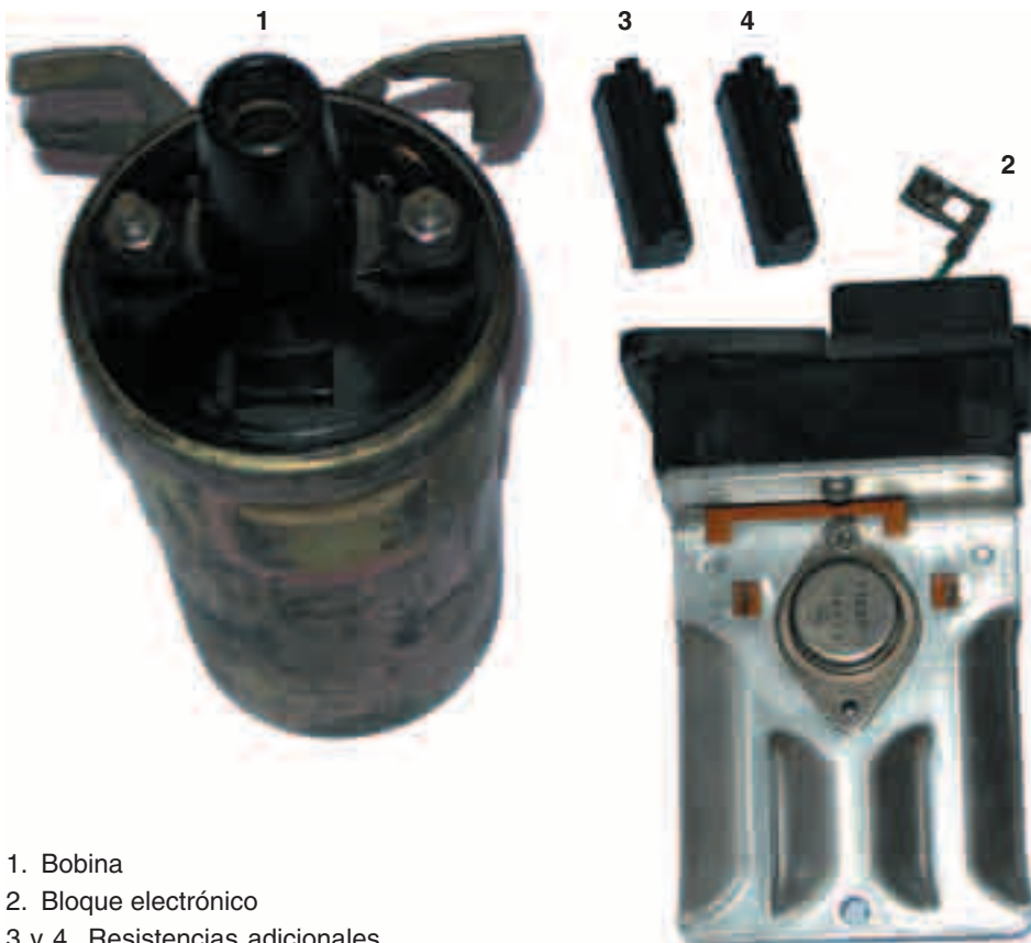
↑ Figura 1.57. Distintos componentes de un encendido transistorizado comandado por contactos.
