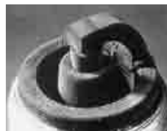
↑ Figura 1.47. Bujía cubierta de hollín.
