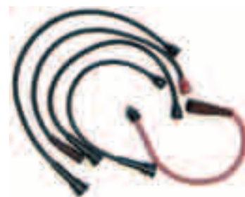
↑ Figura 1.28. Cables de alta tensión.
