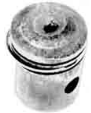
↑ Figura 1.33. Daños ocasionados por autoencendido en un pistón.
