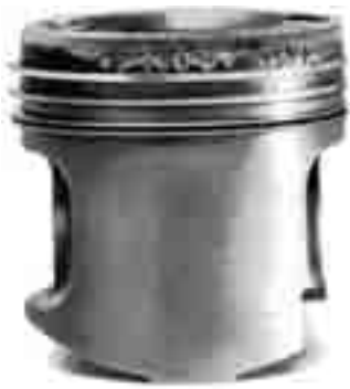
↑ Figura 1.36. Daños ocasionados por detonación en un pistón.
