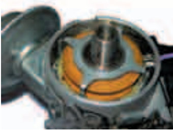
↑ Figura 1.66. Generador de impulsos según el principio de inducción.
