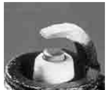
↑ Figura 1.55. Bujía con desgaste por quemadura de electrodos.
