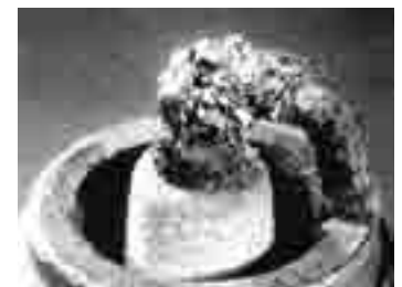
↑ Figura 1.34. Daños ocasionados por autoencendido en una bujía.
