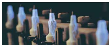
Comprobación de aisladores a 40.000 voltios: Las bujías de encendido Beru deben demostrar su fiabilidad en el banco de pruebas antes de la fabricación en serie.
